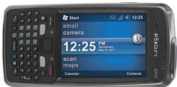
Der integrierte Beschleunigungssensor des EP10 ermöglicht die Drehung der Bildschirminhalte abhängig von der Lage des Gerätes.
